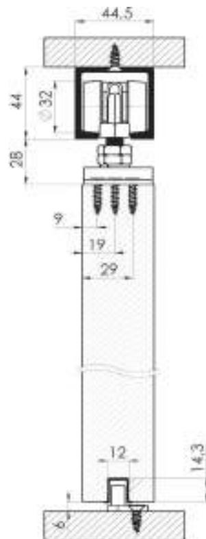
SKS 200 S Kapak Sistemi bir dolapta maksimum 200 kg. Ağırlığında kapak uygulanır.
